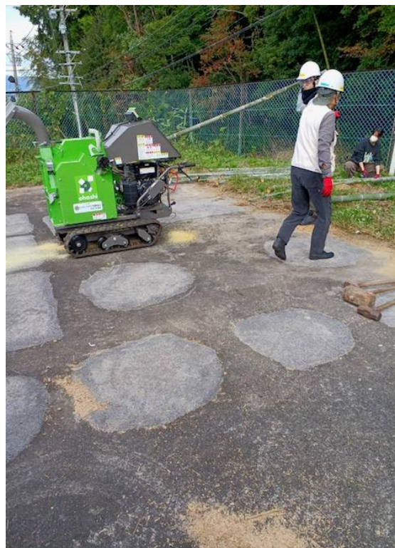
チップー車(粉碎機)にて、間伐竹材による 竹チップ・竹粉づくり作業実習体験
