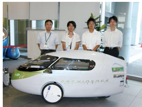
開発チームの皆さん(左端:チーム代表の宮村さん) 第1種原動機付自転車(ミニカー)のナンバープレートを取得。公道で走行可能です。 最高時速:75km/h 1充電の走行距離:90km
